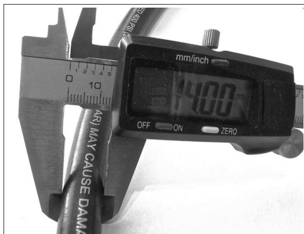
Ancien flexible MP de 14 mm de diamètre externe (uniquement pour les anciens Auto-Air)
