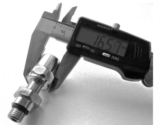
Nouveau modèle de connecteur rapide (Flexible EV50) – Gaine conique 16,57 mm de diamètre
